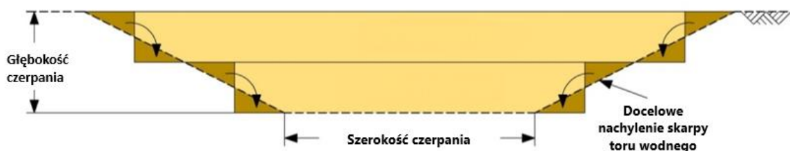
Fig. 5. Skema for fjernelse af jord på havbunden
