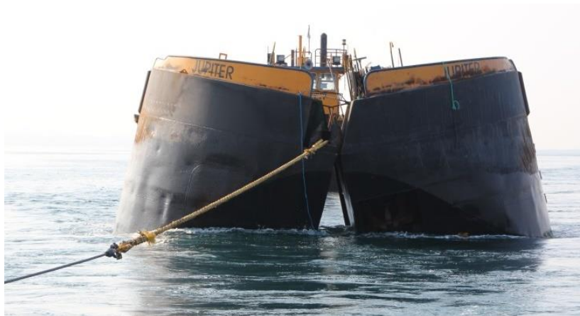
Fot. 3. Åbning af klapperne i bunden af klapprammen
