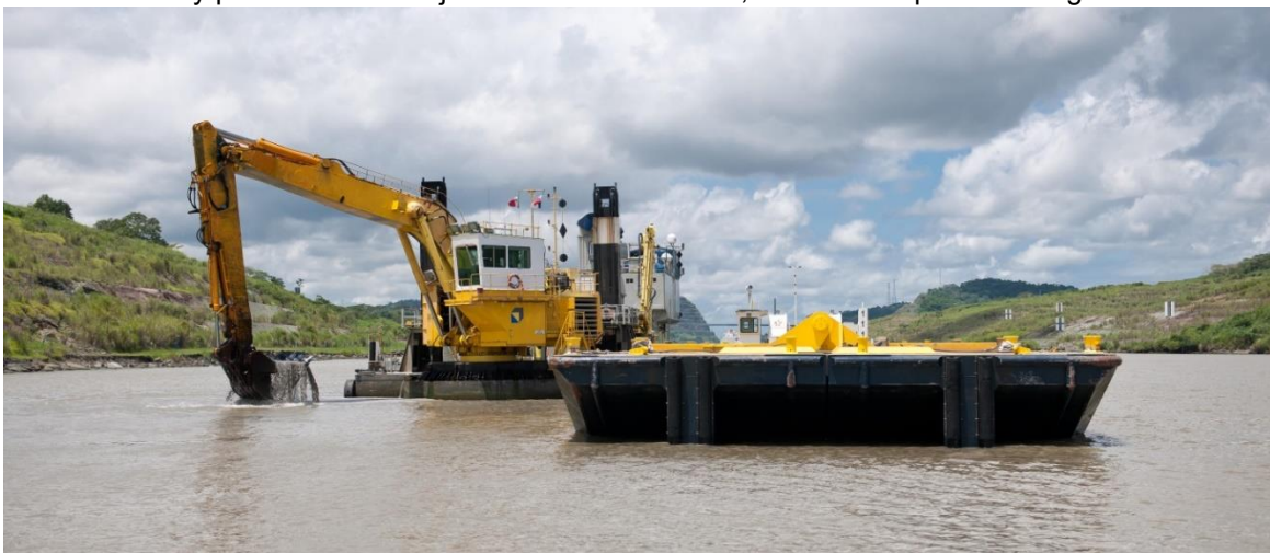
Fot. 2. Backhoe-opmudringsfartøj med klappram under drift
